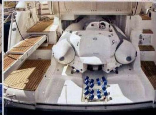
Sopra, il garage per il tender con portellone ad apertura idraulica e verricello di alaggio e varo.
